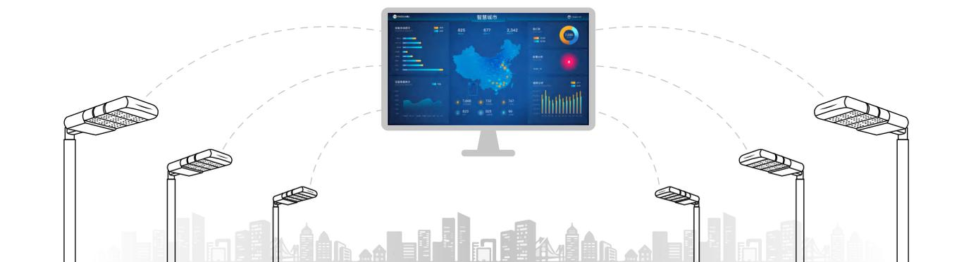
隧道照明控制方式优先推荐工业PLC（可编程逻辑电路），此控制方式成熟、稳定、可靠，兼容隧道照明调光、调色温，配合隧道回路分段控制实现最优照明控制效果。隧道照明调光系统分为现场调光控制箱和远程总控上位机两部分，每个控制箱可扩展多路控制端口，根据现场的布灯方式，按区域分段如入口段、过渡段中段、出口段等进行分组调光或调色温，上位机则实现各洞内照明色温和亮度的远程控制和管理。
